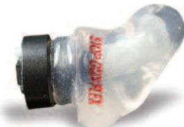
Antibruit électronique réalisé en silicone souple équipé d'un système d'amplification à 3 échelles : +9, +15 ou +25 dB, permettant une augmentation de l'environnement sonore et une suppression du coup de feu. Faceplate de type ER clipsable sur l'embout. Fonctionne avec piles. Autonomie 160 heures.
